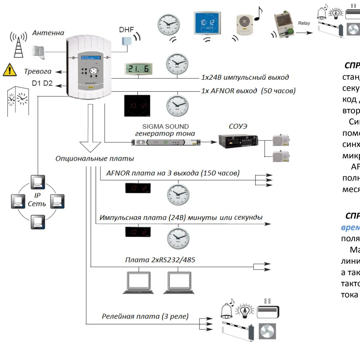
**СПРАВКА:** *Временной код AFNOR* стандартизирован. Каждую секунду главные часы генерируют код для синхронизации вторичных часов.
